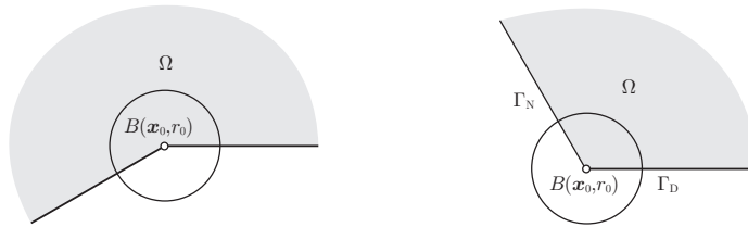
(a) 同一種境界で開き角が \alpha > \pi (b) 混合境界で開き角が \alpha > \pi/2
