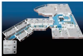
マルチエージェントによる避難シミュレーション buildingEXODUS http://tpforum8.co.jp/forum8lib/pdf/EXODUS-201011.pdf
