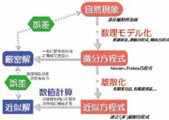
図1.数値シミュレーションの概念図。斜体文字は非圧縮粘性流れの場合の対応する例。
